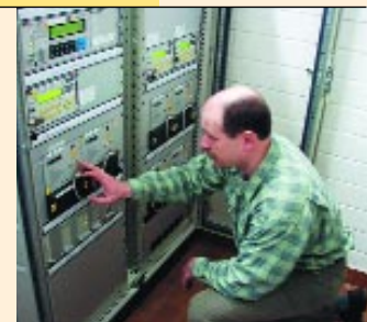
Herr Weber, Saarferngas, bedient den Elster-Datenspeicher DS-100
