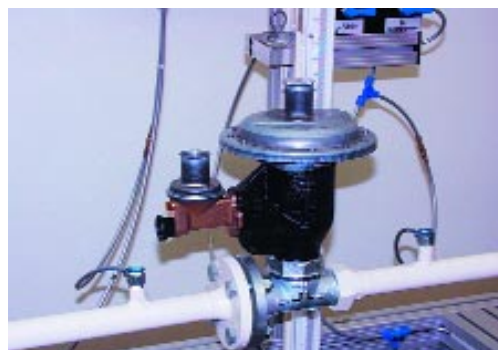
Abb. 2: Regler mit Einrohranschluss im Prüfstand
