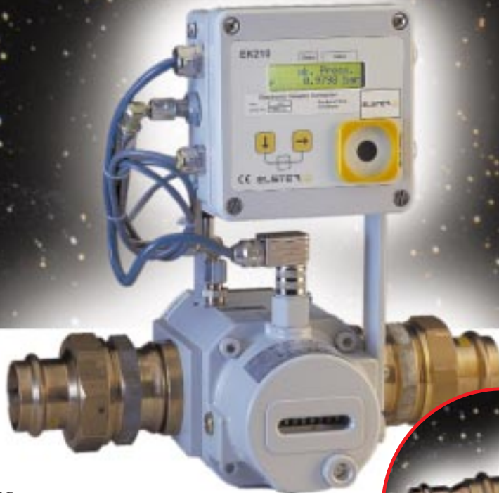
Abb. 6: Anschluss des RVG+EK210 mit ELSTER-Messingdrehteilen an Fittings in der Pressverbindungstechnik mit Reduzierstücken (rechts) und ohne (oben).
