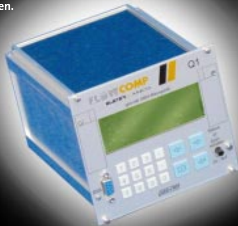
Abb. 1: Gasbeschaffenheitsmessung mittels Korrelationsverfahren mit spektroskopischen und thermischen Messgrößen
