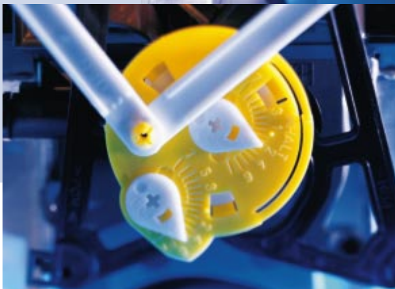
Bild 2: Die patentierte Zeigerjustage zur Messwerkssynchronisation
