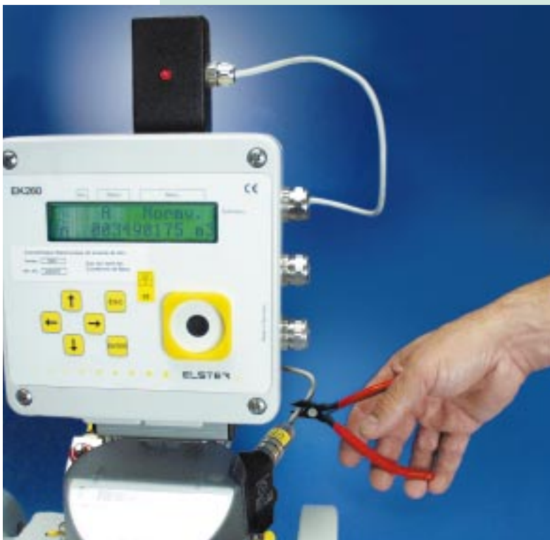
Abb. 2: Unterbrechung der Signalleitung erzeugt eine Meldung
