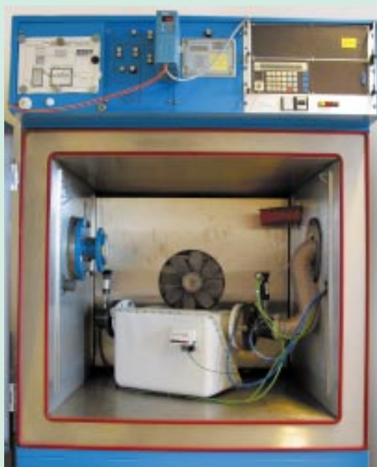
Abb. 1: Balngaszähler BK-G65 in der Klimakammer
