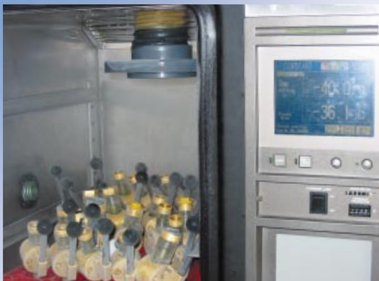
Abb. 1: Test in der ELSTER-Klimakammer bei -40 °C ... alles paletti!
