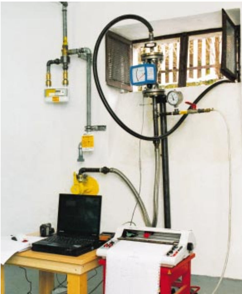
Abb. 3, links: Eine Versuchsanordnung mit Messgeräten und Schreibern hielt genau fest, was bei dem simulierten Baggerangriff auf die Gasleitung passierte.
