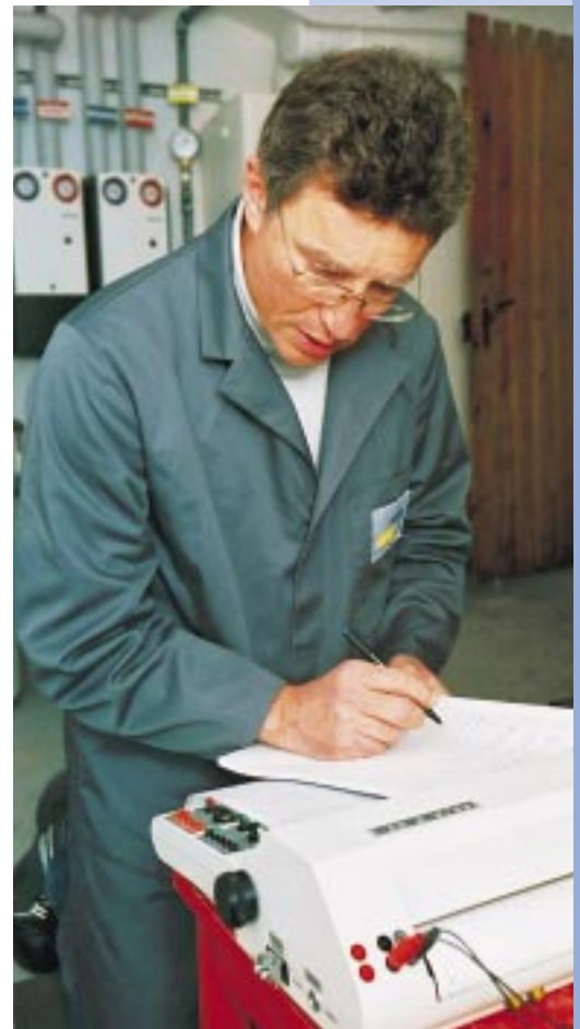
Abb. 4, rechts: Ein kalibrierter Schreiber zeigt dem Versuchsingenieur Dieter Hanselmann die Schließwerte des Gasströmungswächters an.
