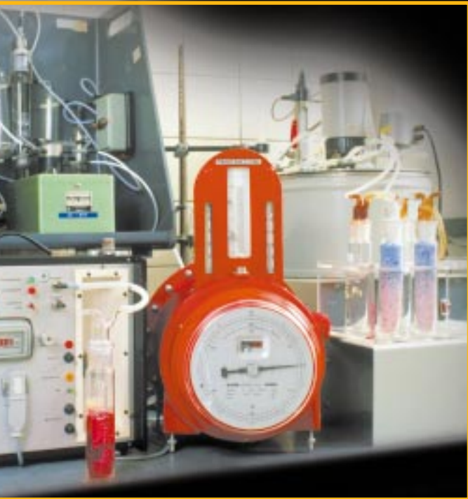
Experimentiergaszähler in trockener (links) und in nasser Bauart (rechts)
