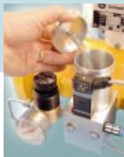
Abb. 3: Turbinenradgaszähler mit automatischer Ölpumpe
