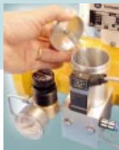
Abb. 3: Turbinenradgaszähler mit automatischer Ölpumpe
