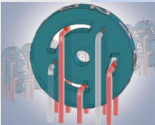
ENCODER-Prinzip mit Lichtschranken
