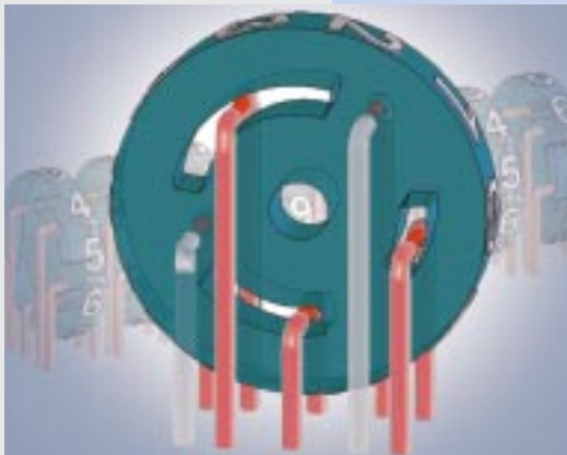
ENCODER-Prinzip mit Lichtschranken
