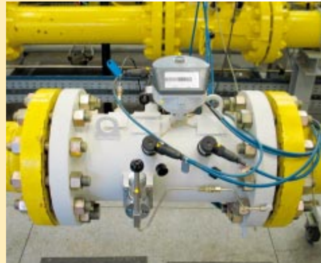
Prüfling DN 200, G 1600, ANSI 600 und einem Prüfdruck von 45 bar
