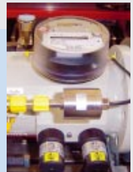
Abb. 2: EK260 – neuer externer Druckaufnehmer
