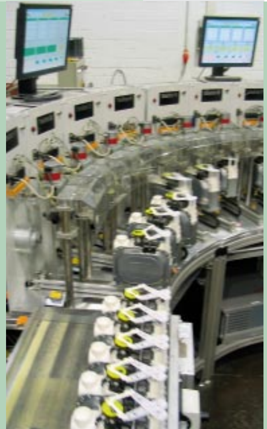
Abb. 3: Automatische Vorprüfung der Messwerke
