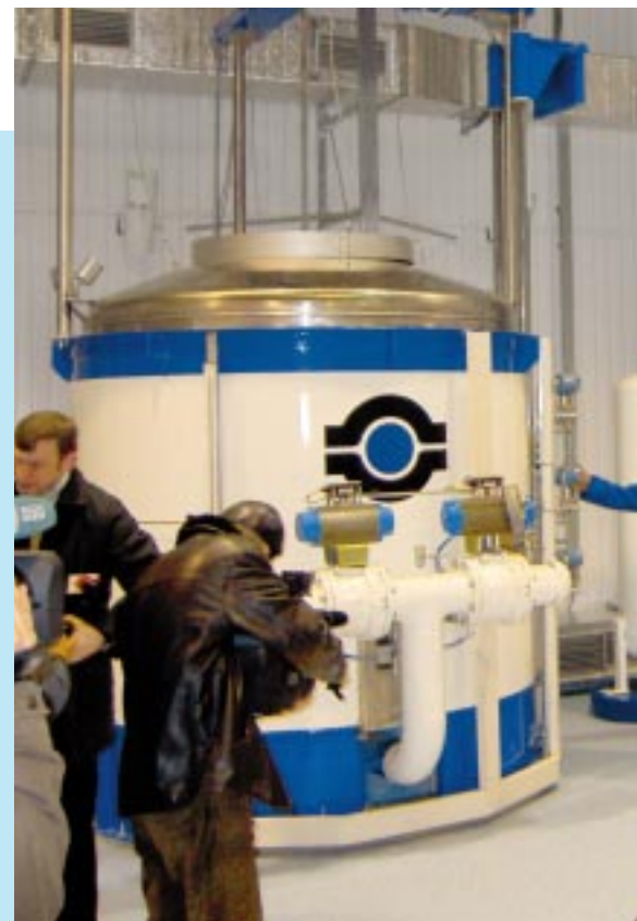
Abb. 2: Glocke und Wägetank als Primärnormale
