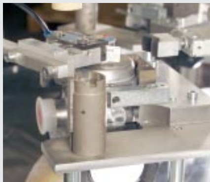
Fabrikschild wird automatisch appliziert
