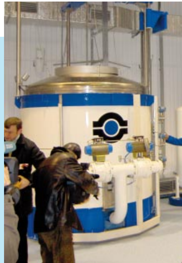
Abb. 2: Glocke und Wägetank als Primärnormale
