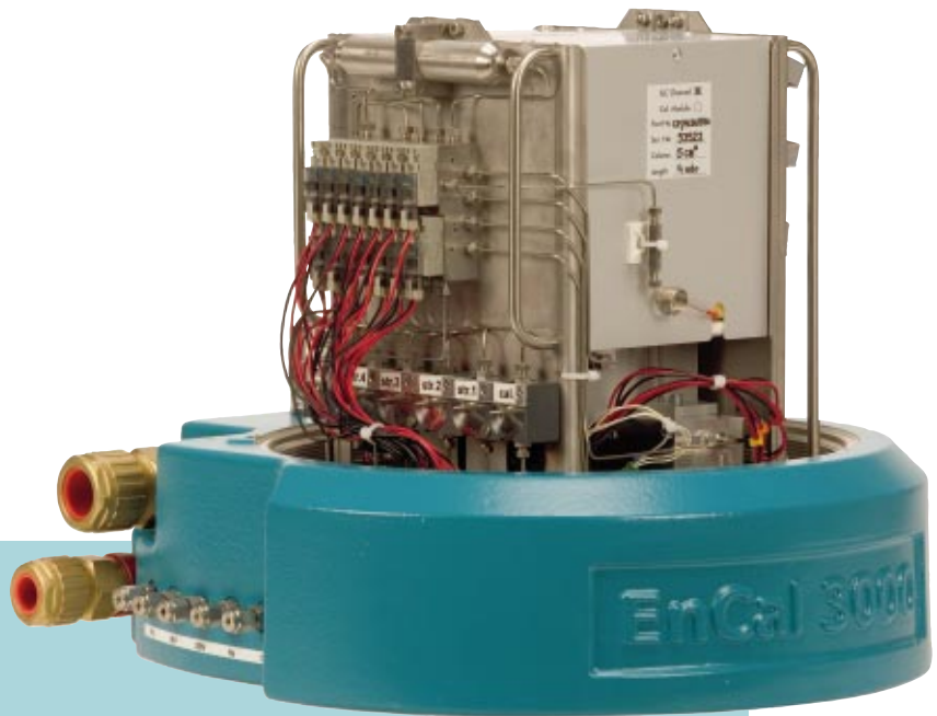
Abb. 3: Messwerk des EnCal 3000 im Exd-Gehäuse. Integration der Chromatographiemodule und der Stromaufschaltung in Double-Block&Bleed für 5 Probengasströme und Kalibriergas
