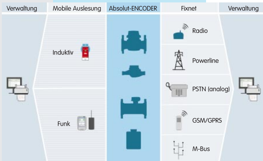
Absolut-ENCODER ermöglicht Migration von mobiler auf Fixnet-Auslesung
