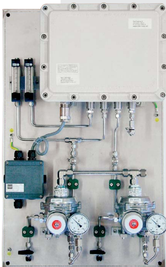
Abb. 1: Messwerk des gas-lab Q1 im EEx_d-Gehäuse auf einer Montageplatte mit Niederdruckreglern für Proben- und Kalibriergas sowie Bypass
