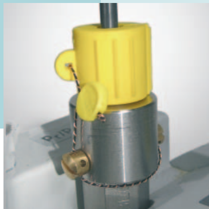
Abb. 3: Adapter für alte Fühlertaschen EBL50/67
