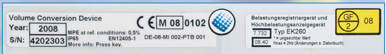
Abb. 3: EK260 – Mengenumwerterfunktion gemäß MID und Datenspeicherfunktion gemäß PTB
