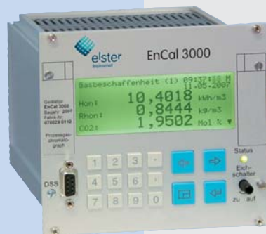
Abb. 3: Prozessgaschromatograph EnCal 3000 mit Prozessrechner zur Kohlenwasserstoff-Taupunktberechnung
