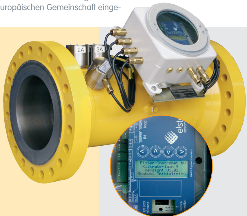
Im Normalbetrieb zeigt das Display die Zählerstände, den aktuellen Durchfluss und den Fehlerstatus des Gaszählers rollierend, im Rhythmus von ca. 2 Sekunden, an.
