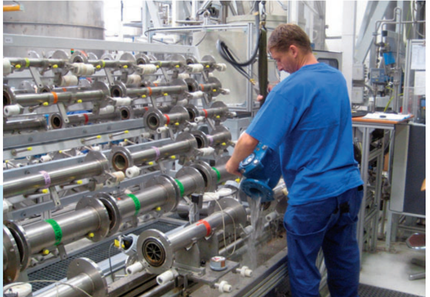
Computergesteuerte Prüfstraße für Gewerbe- und Industrierwasserzähler
