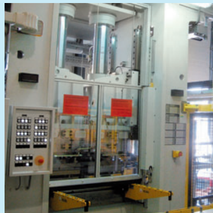
Tiefziehstraße mit moderner Gleitkorntechnologie
