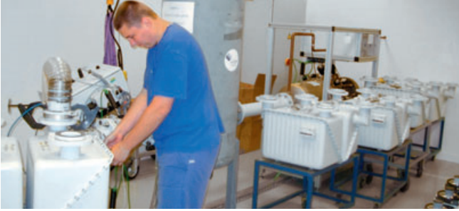
Moderne Düsenprüfanlage für Industriebalgen- und Drehkolbengaszähler
