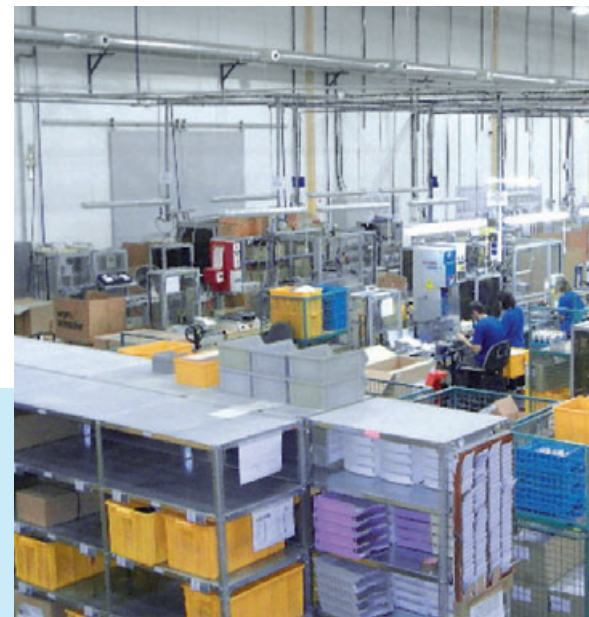
Montagestraße für Messwerke V1, V2
