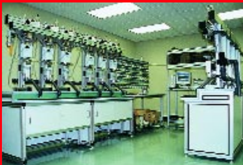
Fig. 3 : The state of the art in sonic nozzle calibration bench Lo más moderno en prueba y calibración de medidores
