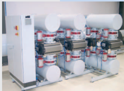
Fig. 2: Master meter section
